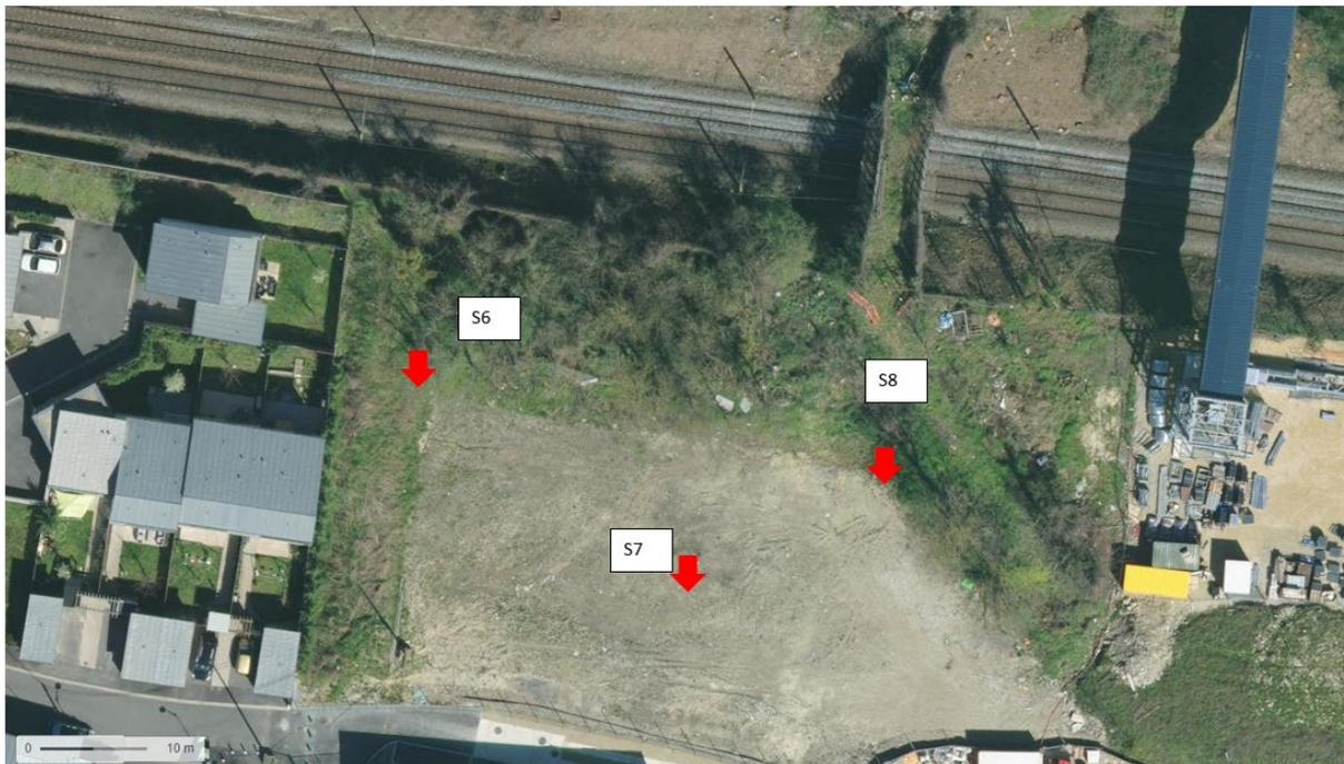
Figure 5 Sondages supplémentaires réalisés à la tarière manuelle sur la partie sud de la ZAC.
